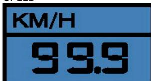
Anzeige der Geschwindigkeit in km/h (0-99.99km/h). Es handelt sich um einen theoretischen Annahmewert, welcher nicht mit dem Wert eines normalen Fahrrades verglichen werden kann.
