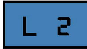
Zeigt den Tretwiderstand in 16 Stufen/Levels an. Zusätzlich zeigt dieser Bereich das Profil der Programme an.
